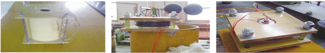
图 9 MOV 能量耐受和工频电压稳定性试验比例单元
