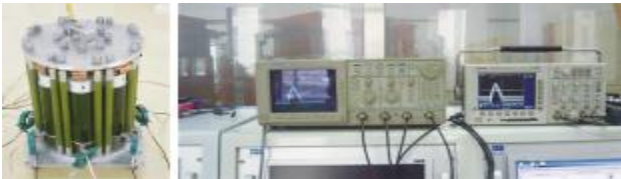
图 10 MOV 多柱电阻片柱电流分布试验情况
